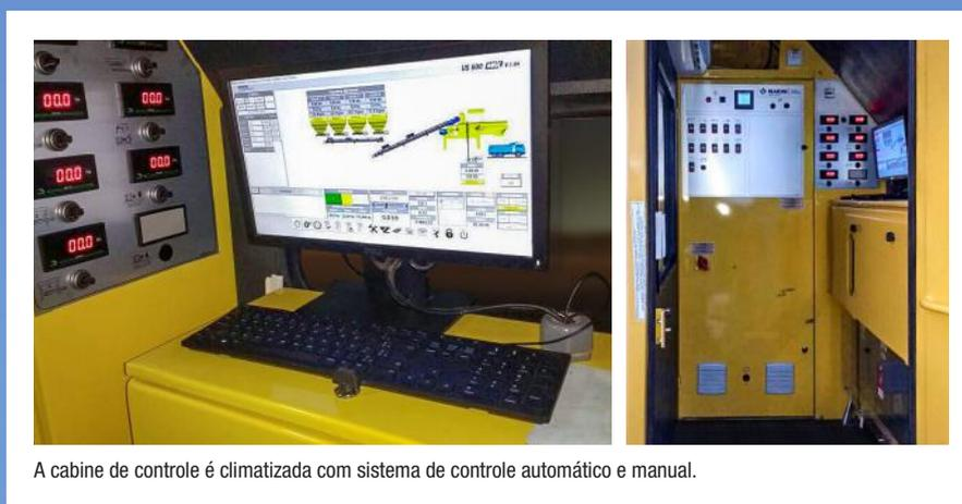
A cabine de controle é climatizada com sistema de controle automático e manual.
