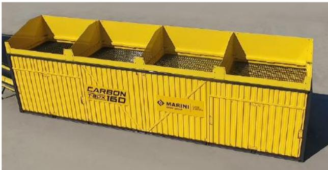
Módulo dosador com quatro silos de agregados
